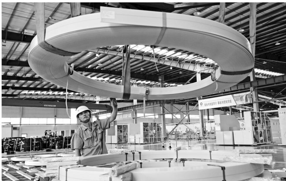
近年来,江苏省连云港市不断加快新材料产业发展,在智能化、绿色化转型方面开启了新一轮的技术升级和创新发展,新材料产业创新实力和市场竞争力的持续提高。图为连云港经济技术开发区中复碳芯电缆科技有限公司生产车间内,工人正在给叶片拉挤大梁板成品进行打包。
