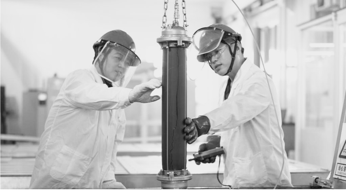
近年来，河北省沧州市孟村回族自治县积极引导管道装备制造企业通过升级改造、创新发展等模式做大做强，支持中小微企业聚焦专精特新，融入集群产业链条；健全科技成果转化机制，推动传统管道装备制造产业转型升级。图为工作人员在河北一塑管道制造有限责任公司静液压实验室进行产品检测。
