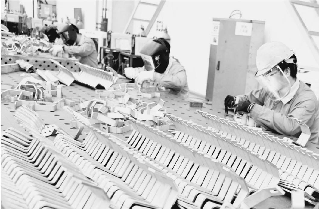
江苏省无锡市锡山区的大明国际进出口有限公司携手大明精工制造有限公司，共同服务了一批出口欧洲某国的新能源光伏支架产品，该批产品日前已从上海港发运。图为大明精工制造有限公司的工人正在焊接光伏支架。
