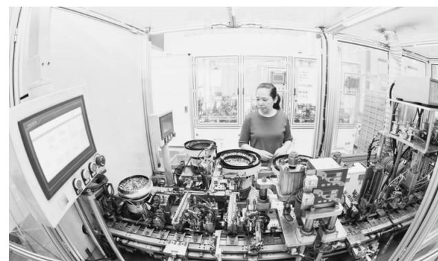
图为位于江苏海安高新区的江苏联科汽配公司新能源汽车配件车间里，员工正在赶制电动玻璃升降器。中新社发 顾华夏 摄
