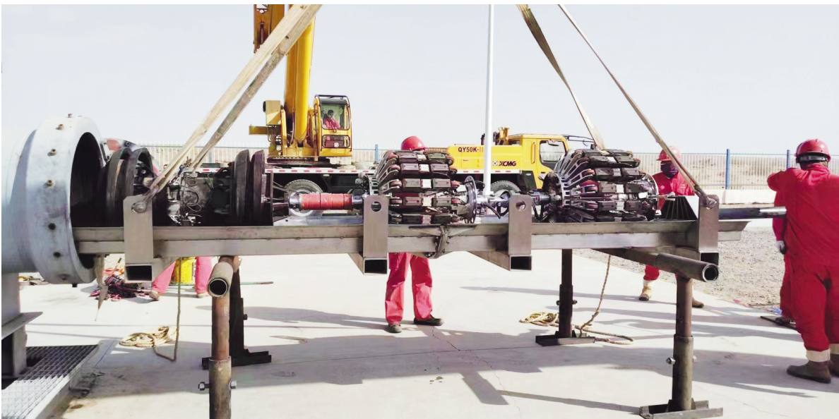
国机集团研制的711大变径漏磁检测器近日在土库曼斯坦天然气管道收球成功。检测器运行期间,速度相对稳定,信号良好;检测完成后,检测器外形完好,探头无破损,检测数据完整、充足,信号清晰,这标志着检测任务圆满完成。国机集团供图
