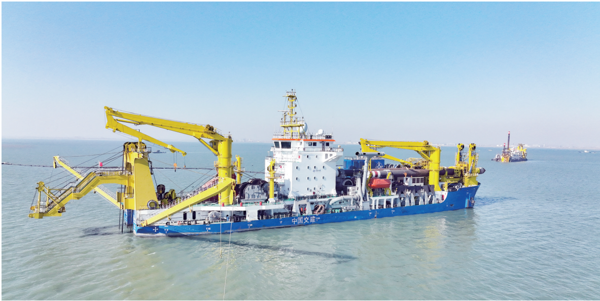
我国自主设计建造的亚洲最大自航绞吸挖泥船“天鲲号”,时隔一年再次来到江苏连云港赣榆港区,承担赣榆黄海粮油科技产业园航道工程建设。据了解,“天鲲号”全船长140米、宽27.8米,最大挖深达35米。 中新社发 司伟 摄
