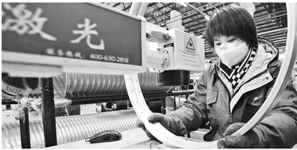
近年来，河北省唐山市芦台经济开发区抢抓京津冀协同发展机遇，积极承接京津产业转移，扶持培育当地企业快速发展。据介绍，目前该开发区承接自行车零部件、现代家居、汽车配件和高端装备制造等京津转移产业项目达138个。图为在该经济开发区的一家自行车生产企业，工人利用激光机为车圈打标。新华社记者 杨世尧 摄
