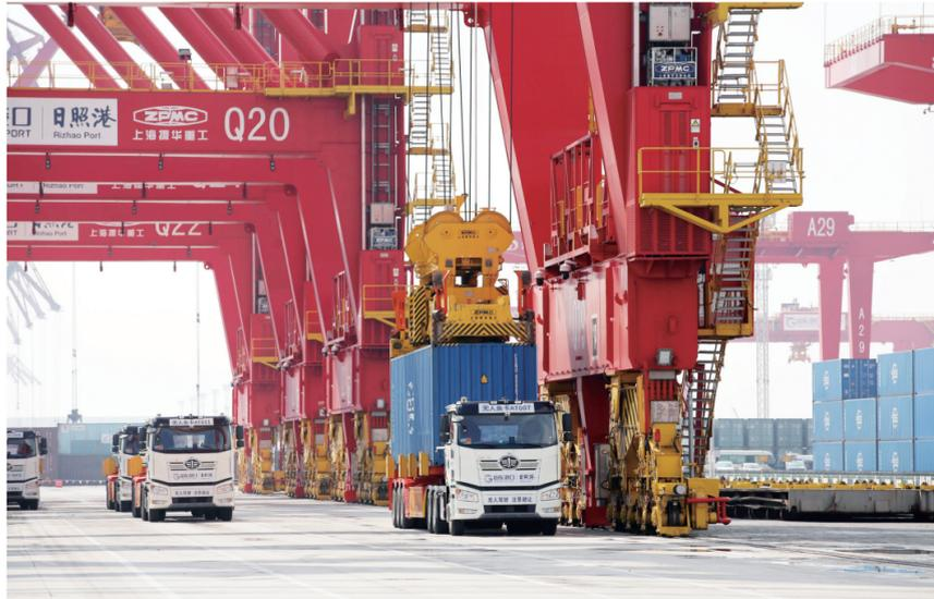
全球首个顺岸开放式全自动集装箱码头近日在山东港口日照港正式启用。该码头为全球港口提供了传统码头改造升级为全自动化集装箱码头的“中国样本”,对引领全自动化集装箱码头的“低成本、短周期、见效快”建设具有示范意义。图为日照港全自动化集装箱码头桥吊将集装箱放到无人驾驶集装箱卡车上。
