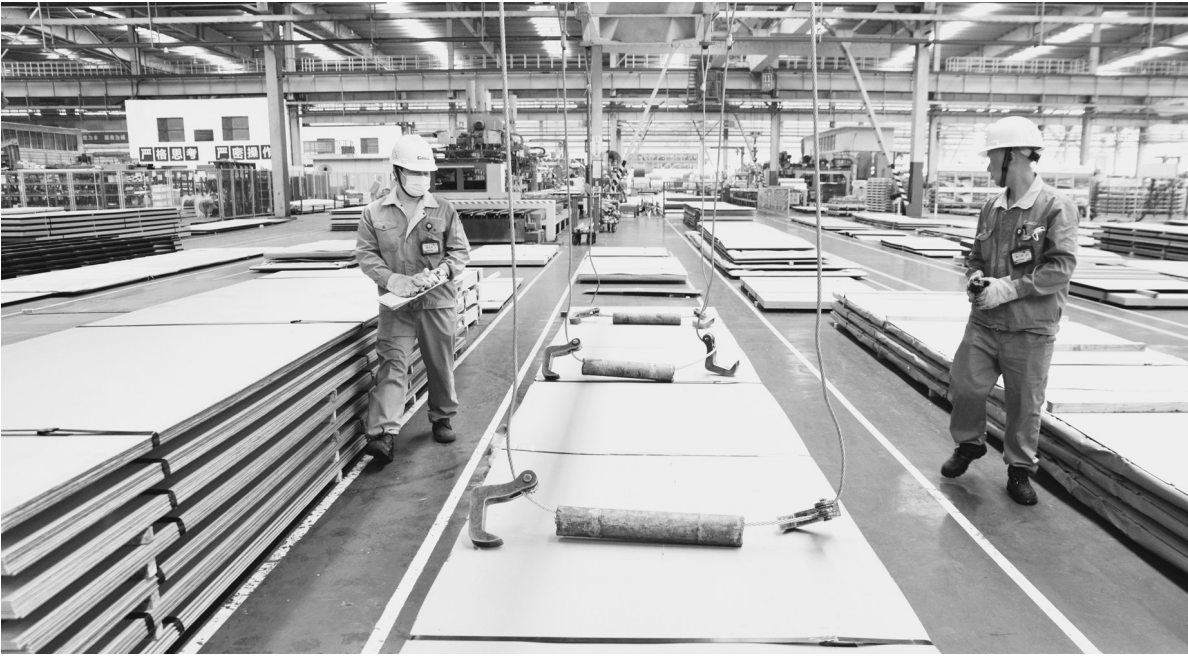
8月25日,位于江苏省靖江市工业园区的大明金属科技有限公司,工人们正在加工生产线开平、吊运、发货一批符合美国标准的304不锈钢材料,该材料用于LNG不锈钢化学船舶上全球LNG储运载体—最新版集装箱式罐体。
