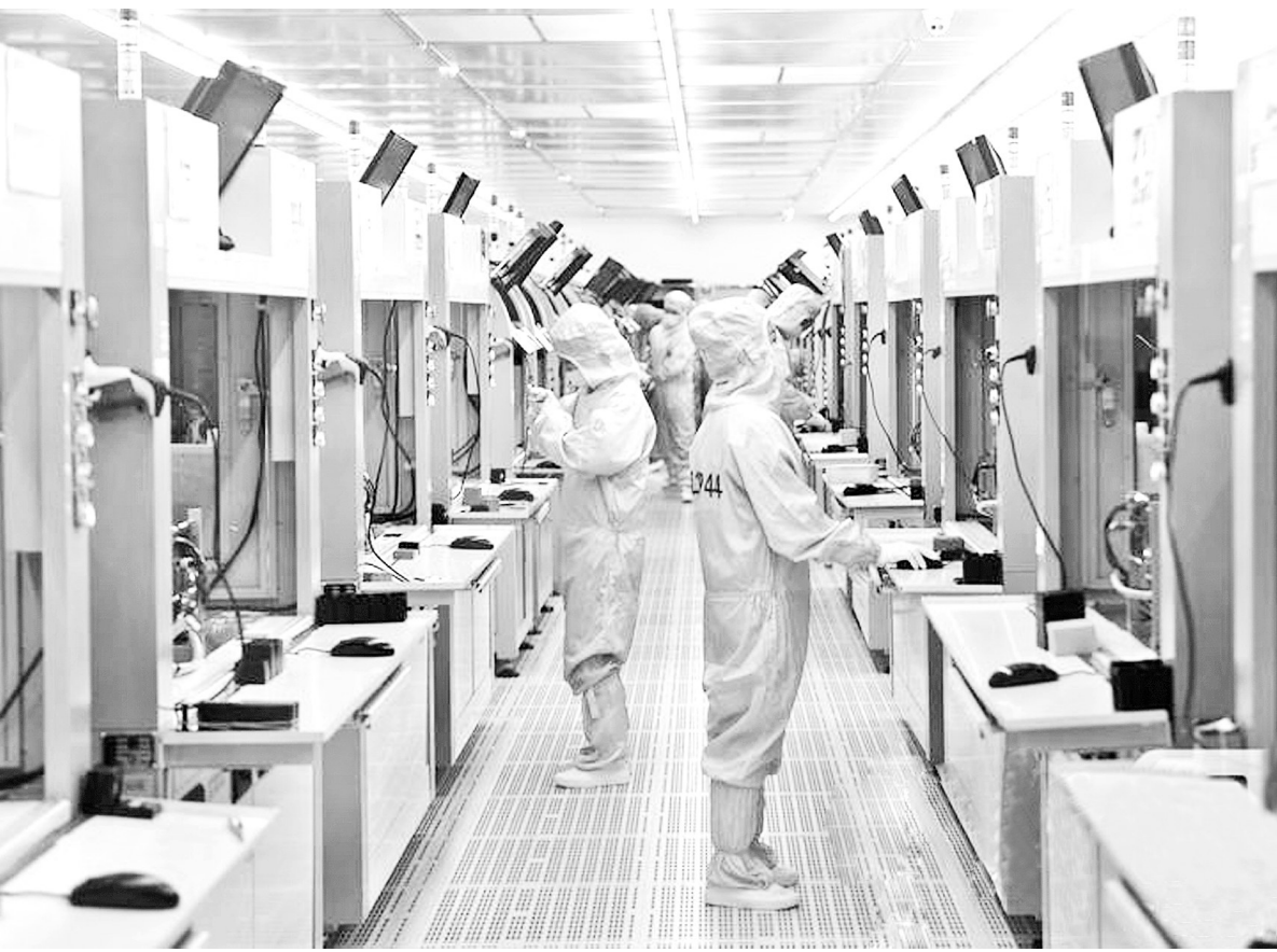
5月25日,浙江省嘉兴市嘉善县的一家科技公司内,工作人员在晶圆封装测试车间内作业。该公司主要生产CMOS图像传感芯片,并向国内多个手机品牌供货。
