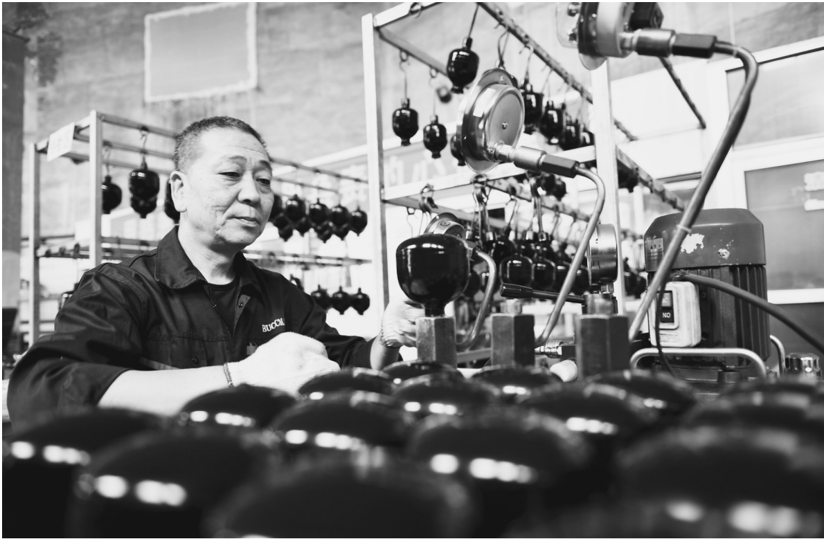
近年来，河北省张家口市宣化区以引领企业自主研发为核心，不断创新发展模式。布科玛蓄能器张家口有限公司自主研发的隔膜式蓄能器产品取得了美国ASME和欧盟PED证书，打破了蓄能器这一工程机械液压系统核心组件长期依赖从德国、美国进口的状况。图为工人在进行产品检测。
