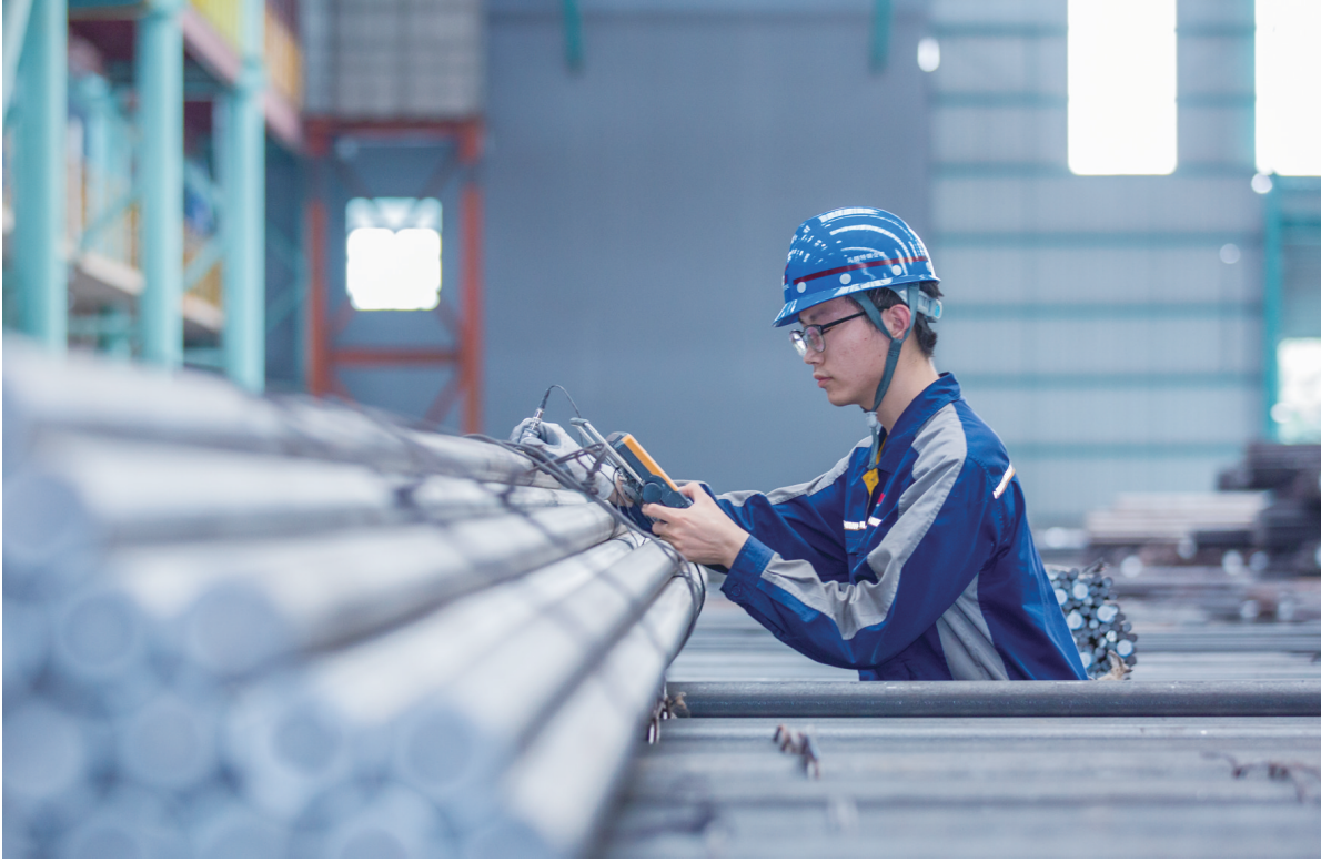
中国宝武马钢股份特钢公司优质合金棒材产线建成投产一年多来,通过不断创新突破,已成功开发铁路和汽车弹簧钢、高端制造齿轮钢、高端轴承钢等高端钢种120余个,市场份额不断提升,有力支撑我国高端制造业发展,解决基础材料难题。图为中国宝武马钢股份特钢公司优质合金棒材产线员工正对高端特钢产品进行无损探伤检测。
