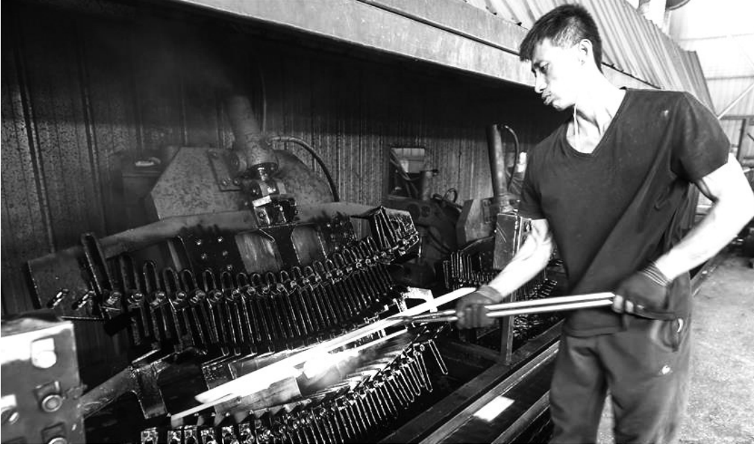
河北省大城县南赵扶镇是该县农机配件行业传统生产基地。疫情发生以来,南赵扶镇引导企业做好风险防范,与世界各地客商开展方式多样的合作,出口订单不降反升。截至目前,该县农机配件行业出口总销量达8000余万元,较去年同期增长30%。图为当地一家板簧生产企业员工在板簧淬火生产线上作业。
