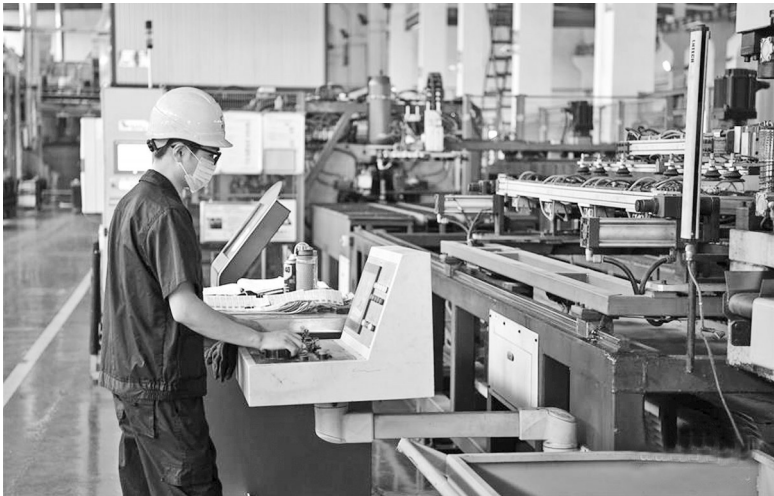
在位于苏州市吴江区汾湖高新区的康力电梯股份有限公司生产厂区,工作人员在操作机器加工电梯门板。
