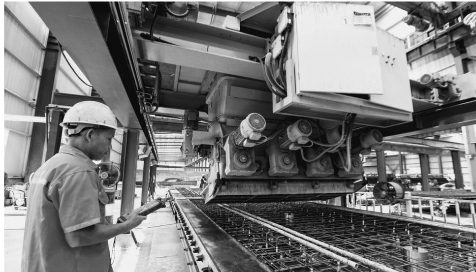
中铁四局庐江轨道板厂主要承担新建合肥至安庆高铁142公里长的50288块轨道板CRTSIII型无砟轨道板的预制及装车任务。板厂引进国内最新一代生产流水线，10分钟就能完成一块轨道板的生产。板厂还采用先进的3D智能检测系统，采用智能机器人扫描轨道板，检测一块轨道板只需4分钟，检测成果精密为0.2mm。图为工人在板厂里预制高铁轨道板。
