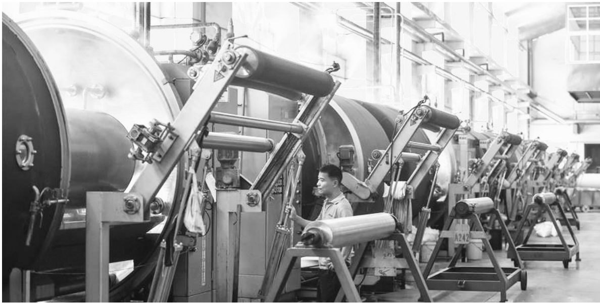
福建省石狮市是纺织服装重要出口地。该市采取一系列环保倒逼措施,促使越来越多服装纺织企业投入资金引进现代化、自动化设备进行技术改造。图为在福建省石狮市宏兴染整织造有限公司,工人在操作新型染缸。该染缸可收集废水和热能,实现循环再利用。
