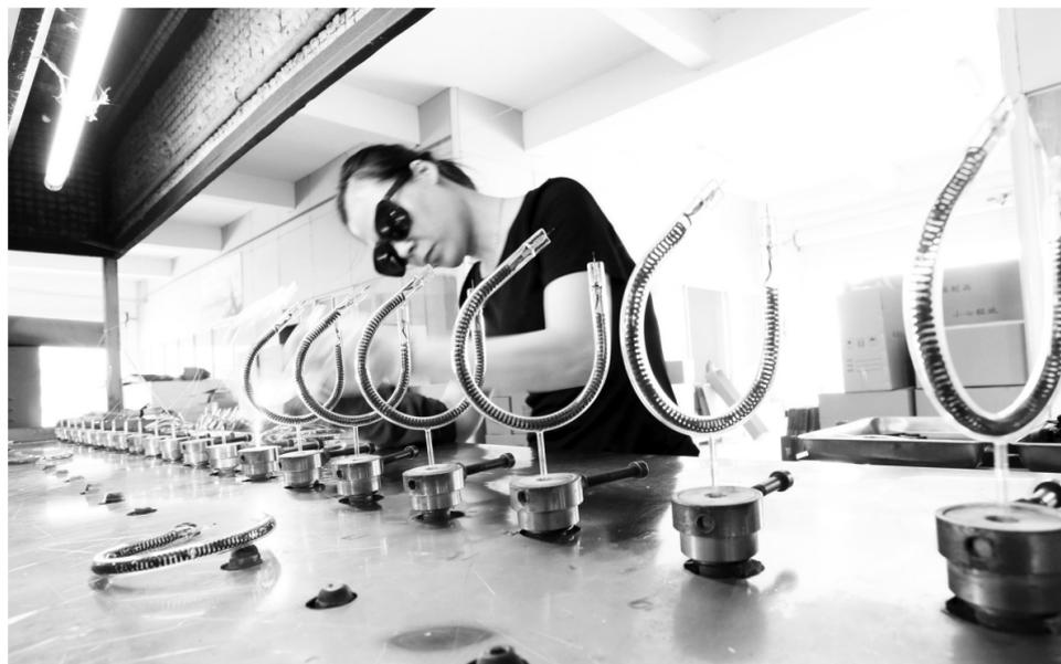
今年以来,江苏东海县照明电器企业充分发挥先进的工艺装备优势,持续加大科研力度,攻关高端生产工艺,生产出的卤素加热管、碳纤维发热管、卤钨灯系列产品远销欧美、日韩、东南亚、中东等地区。图为江苏东海县安峰镇一家企业内,工人在生产出口欧美的碳纤维发热管。 中新社发 张开虎 摄
