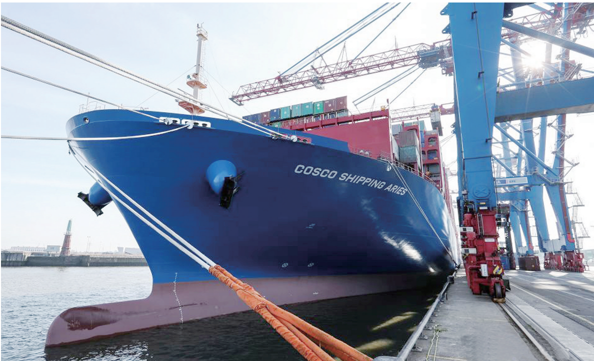
中国远洋海运集团首艘两万标箱级集装箱船“中远海运白羊座”号2月23日停靠德国汉堡港。这是中远海运集团向远东至西北欧班轮航线投入的首艘这一级别的超大集装箱船,将进一步提升全球集装箱运输服务能力。据中远海运欧洲一负责人介绍,“中远海运白羊座”号是我国自主研发的新一代船型,船长400米,型宽58.6米,型深30.7米,最大载重量可达19.7万吨,甲板面积超过4个标准足球场,可称作“海上城堡”,是全球装箱量最大的货轮之一。
