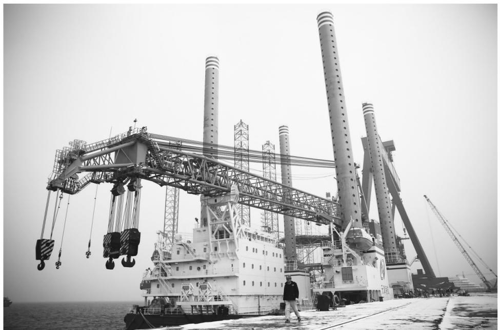
1月28日,国内目前起重量最大的风电施工平台“港航9”在青岛西海岸新区海西重工有限责任公司码头交付。这座平台是为天津港航工程有限公司量身打造的,是目前主流的风电安装平台,集风电安装、海上打桩、起重打捞等多功能于一体的海上施工自升平台,最大作业水深40米,最大起重量为1200吨,最大起升高度可达110米,是目前国内交付的起重量最大、功能最全面、技术最先进的海上风电施工平台。中新社发 张进刚 摄
