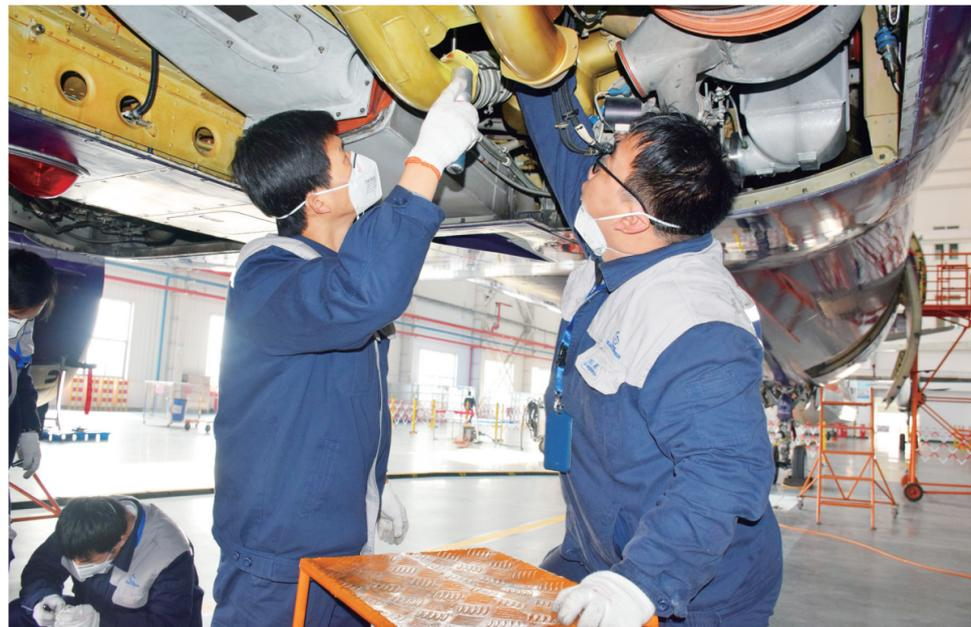
1月4日,贝迪克凌云(宜昌)飞机维修工程有限公司维修首架入境国际飞机。当天维修的是来自柬埔寨澜湄航空公司的一架空客A321型XU-961飞机,该飞机维修周期为24天,将完成分解离位件及接近、检查探伤、褪漆和喷漆、装配、称重等主要定检工作。贝迪克凌云公司是中国与以色列首个合资民航飞机维修项目,由以色列宇航工业公司(IAI)下属的贝迪克航空集团与凌云集团合资组建成立。
